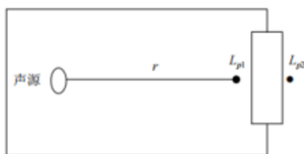
图 4-2 室内声源等效为室外声源图例
